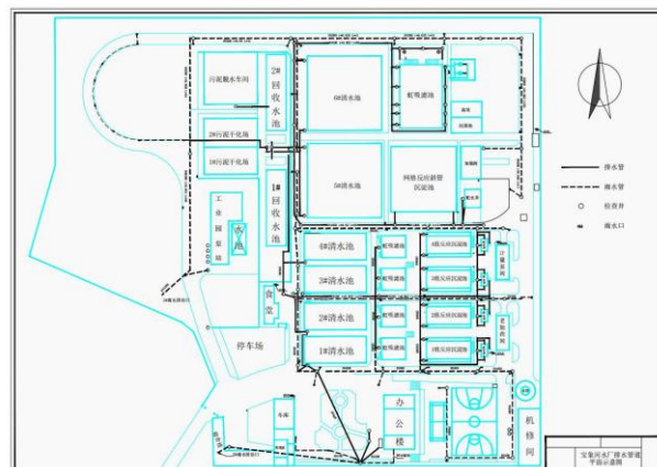
图 4.1-1 项目排水管线平面布置图
