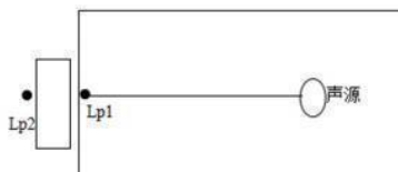
图 4-2 室内声源等效为室外声源图例
