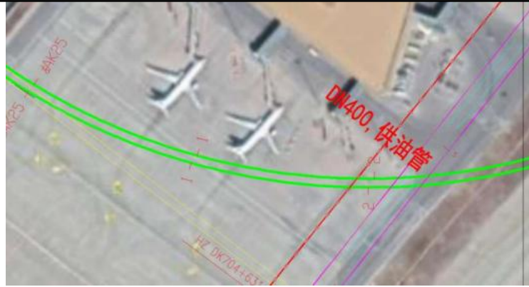
图 2-9 线路与供油管平面位置关系
