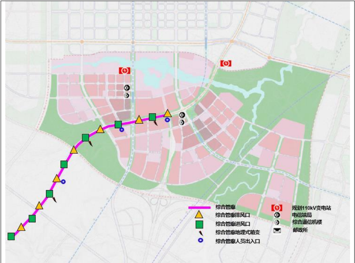
图23 空港大道南段综合管廊系统示意图
